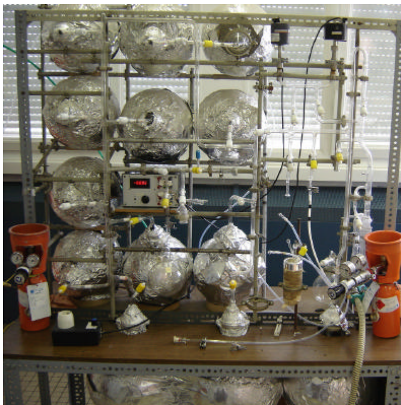
Figure II.3 : Dispositif de préparation des mélanges introduits dans la chambre de combustion de la MCR de Lille.
